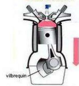
3ème temps de 2-3-4 : phase allumage à  $V = \text{cte}$ . La phase 3-4 détente isentrope (seule motrice)
