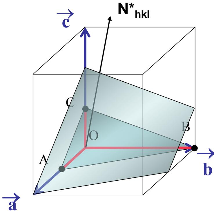
Le plan qui coupe les trois axes en A, B et C est l'un des plans de la famille de plans réticulaires (h k l).
