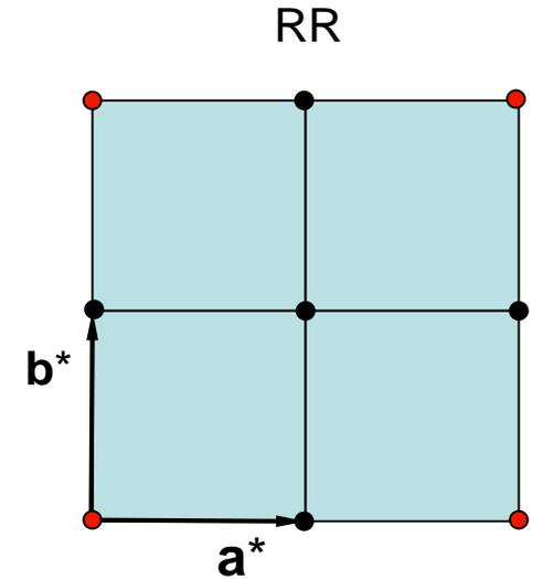
Finalement dans le RR je dois raisonner sur une grosse maille de côté égal à  $2a^*$  en supprimant les nœuds qui se trouvent au milieu des arêtes et au centre des 6 faces. Il reste dans ce gros cube de côtés  $2a^*$ ,  $2b^*$  et  $2c^*$  à regarder ce que devient le nœud 1 1 1.
