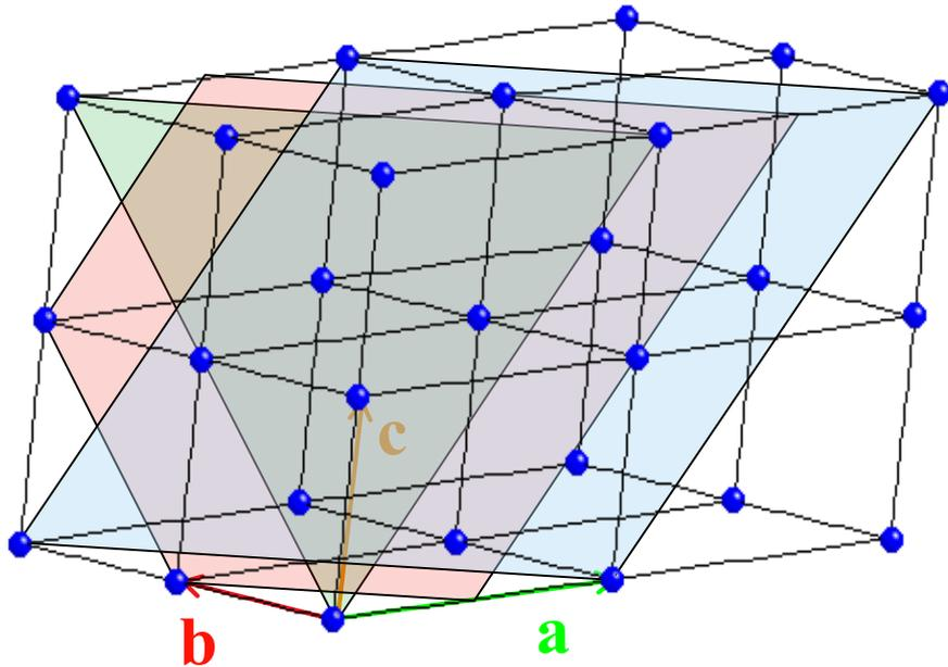
Choisissons parmi ces plans, le plan le plus proche de l'origine et qui coupe donc **a** à **une distance  $a/h$  de l'origine**. Ce plan coupe **b** en un point situé à **la distance  $b/k$  de l'origine** et **c** en un point situé à **la distance  $c/l$  avec  $k$  et  $l$  entiers**.
