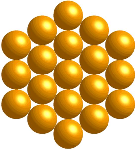
À 2-D, le réseau le plus dense est un réseau hexagonal
