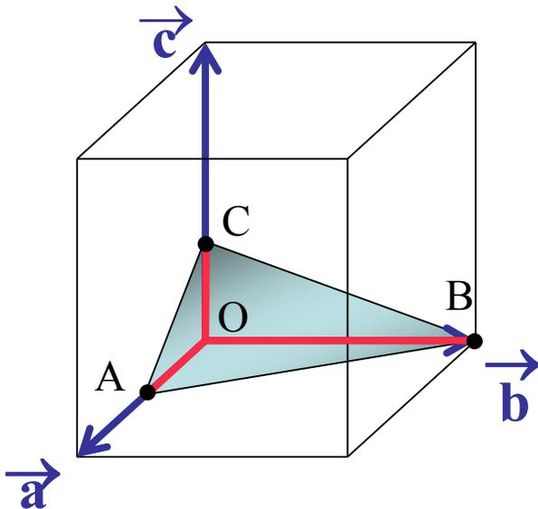
Considérons maintenant le plan de la famille de plans réticulaires (h k l) le plus proche de l'origine, son équation dans l'espace direct est  $hx+ky+lz = 1$  et soient A, B et C les intersections de ce plan avec les trois axes. Les vecteurs **AB** et **AC** appartiennent à ce plan.
