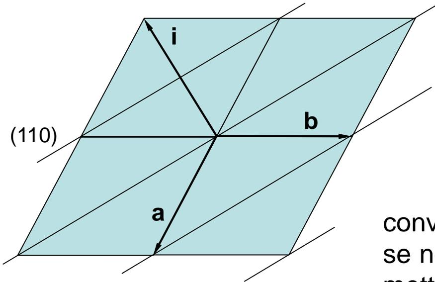
Ces trois bases sont totalement équivalentes. C'est pour cette raison que dans le système hexagonal on utilise 4 indices pour indexer les plans.  $h$  sur  $\mathbf{a}$ ,  $k$  sur  $\mathbf{b}$ ,  $i = -(h+k)$  sur  $\mathbf{i}$  et  $l$  sur  $\mathbf{c}$ . Avec cette
