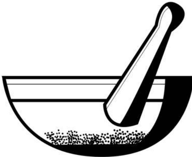
Dans un mortier, le broyage est achevé en écrasant l'échantillon, préalablement émincé, entre deux surfaces abrasives qui glissent l'une sur l'autre. L'échantillon est soumis à des forces verticales (d'écrasement) et tangentielles (d'étirement) par le mouvement du piston, de bas en haut et de rotation. Le broyage est éventuellement facilité par l'adjonction à l'échantillon, de particule fine de sable, de verre, d'alumine ou autre matériel inerte, pour augmenter le pouvoir abrasif du dispositif.
