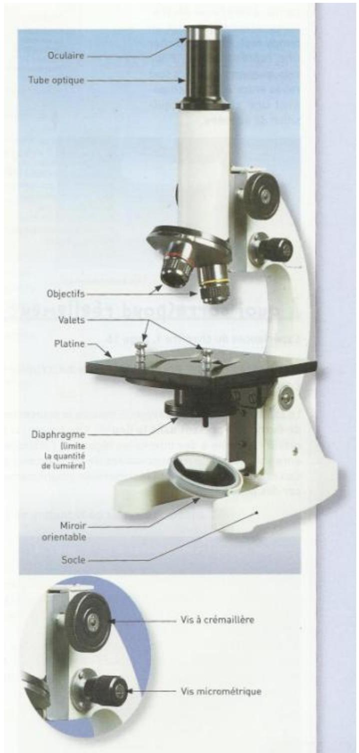
la vis macrométrique de mise au point, remonter le tube jusqu'à l'obtention d'une image nette.
