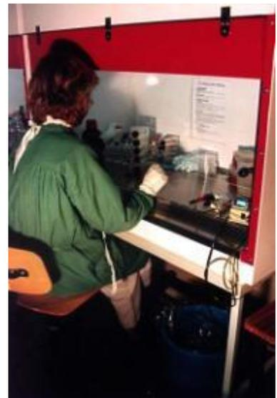
La culture de cellules impose l'utilisation de la hotte à flux laminaire ou poste de sécurité microbiologique afin d'éviter la contamination pendant le travail d'ensemencement et/ou de repiquage.
