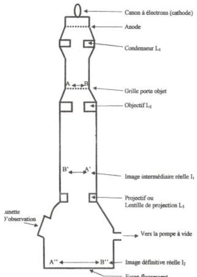
L'image est observée directement sur l'écran rendu fluorescent par le bombardement électronique ou sur une plaque photographique. Le MET permet des grossissements allant de 2000 à un million.
