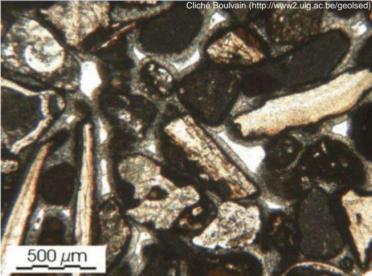
*Grainstone lithoclastique et bioclastique. La cimentation consiste en une frange fibreuse de 60  $\mu\text{m}$ , en croûte isopaque. C'est une diagenèse précoce en zone phréatique marine.*
