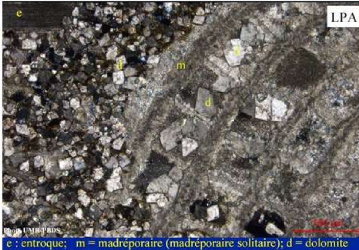
La dolomite de remplacement
