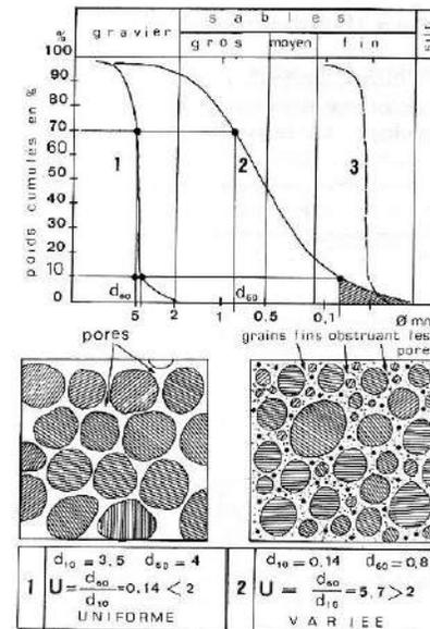
Figure 36 - Qualification d'un matériau meuble par sa granulométrie. Position et pente de la courbe granulométrique. Granulométrie uniforme et variée. Signification du diamètre efficace  $d_{10}$ . 1, gravier à granulométrie uniforme ; 2, gravier sableux à granulométrie variée ; 3, sable fin à granulométrie uniforme.
