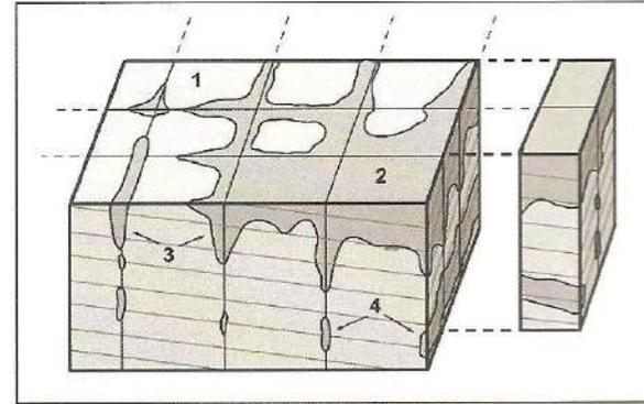
*Bloc-diagramme schématisant montrant les différents types de fantômes. La roche saine (1) est parcourue de nombreuses discontinuités (fractures, joints de strates) qui sont exploitées préférentiellement par l'altération. Dans les parties fantômisées, on distingue les altérations en masse (2), en couloir (3) et les pseudo-endokarsts (4) qui sont caractérisés par la présence d'un toit calcaire.*
