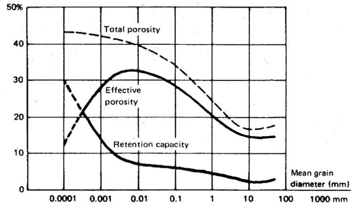
Figure 1.16 Composantes de la porosité en fonction de la granulométrie (de Marsily, 1986)
