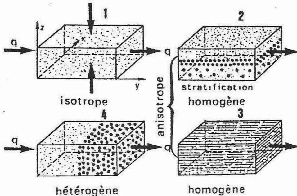
**Figure 37 - Isotropie (1) et anisotropie (2, 3, 4). Homogénéité (2 et 3) et hétérogénéité (4).**
