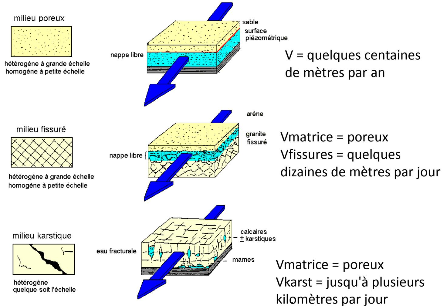
Figure 7-16A: Hétérogénéité des aquifères et vitesse d'écoulement (adapté de DROGUE in GUILLEMIN et ROUX).
