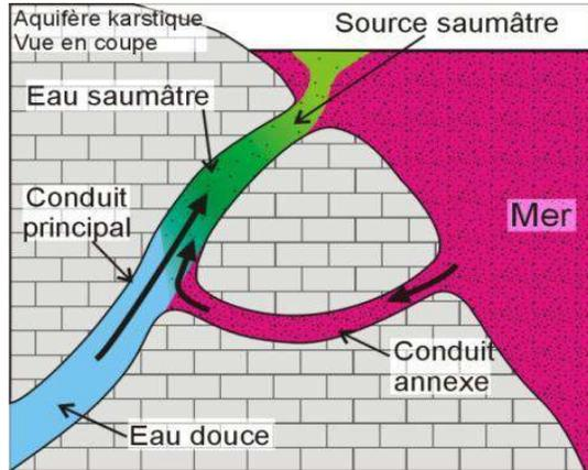
Intrusion par connexion de conduits
