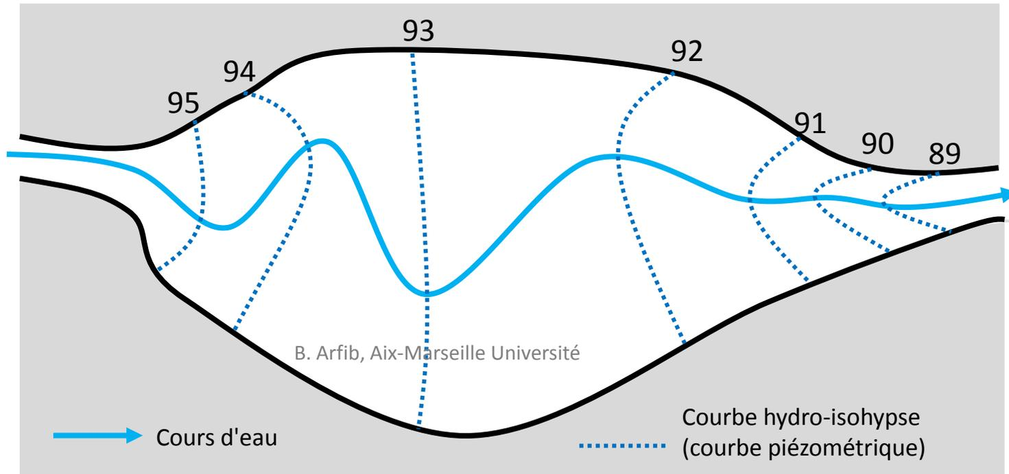
Rivière = Limite à charge imposée (condition de Dirichlet)
