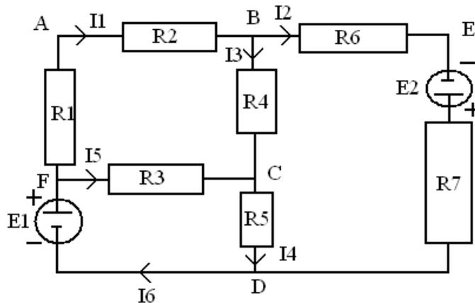
$E_1, E_2$  sont les f.e.ms du réseau et  $R_i$  les résistances. Si nous considérons la maille ABCFA, nous pouvons écrire  $(V_A - V_B) + (V_B - V_C) + (V_C - V_F) + (V_F - V_A) = 0$
