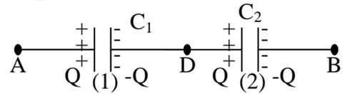
L'ensemble des deux condensateurs de capacités  $C_1$  et  $C_2$  est équivalent à un seul condensateur de capacité  $C$  telle que :  $\frac{1}{C} = \frac{1}{C_1} + \frac{1}{C_2}$ .
