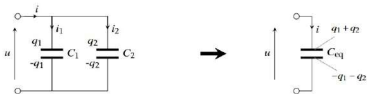
FIGURE I.6 – Capacités montées en parallèle
