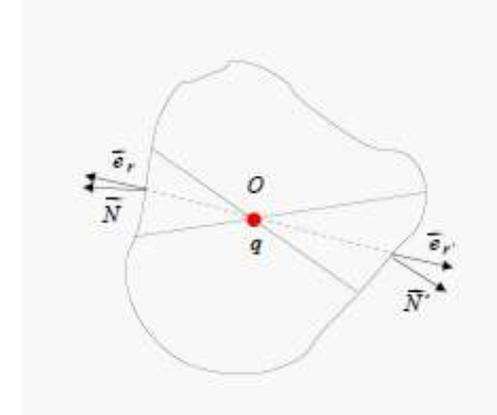
La surface est fermée et entoure la charge  $\Omega = \int d\Omega = 4\pi$
