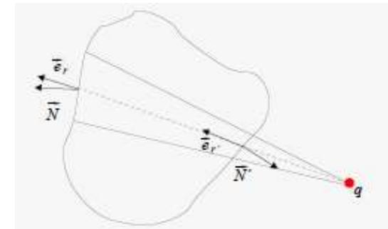
D'où  $d\phi + d\phi' = 0 \longrightarrow \phi(\text{total}) = 0$  Le Théorème de Gauss est vérifié
