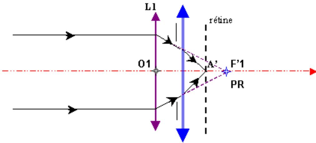
Pour un objet situé à l'infini et avec une lentille convergente L1, l'image est à nouveau sur la rétine.
