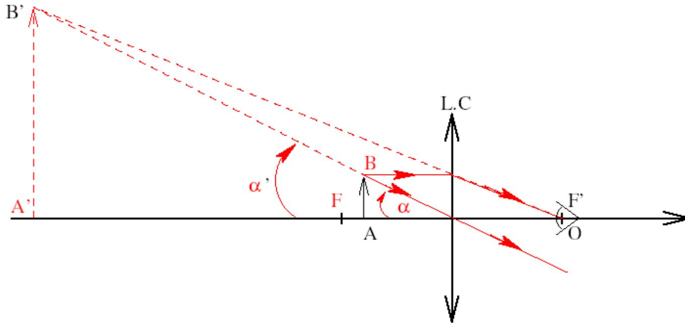
La loupe donne d' un objet réel, placé à côté du foyer objet, une image virtuelle droite agrandie.
