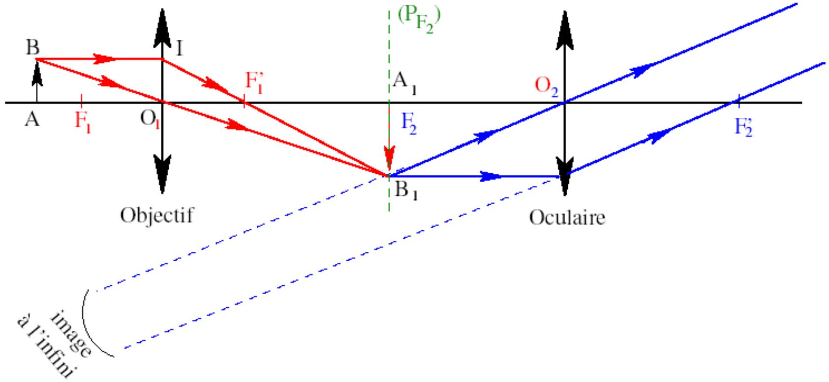
Les triangles  $(IO_1F'_1)$  et  $(F'_1A_1B_1)$  sont semblables avec  $A_1 \equiv F_2$  ( $A_1B_1$  est située sur le plan focal objet de l'oculaire  $P_{F_2}$ ). On peut écrire :
