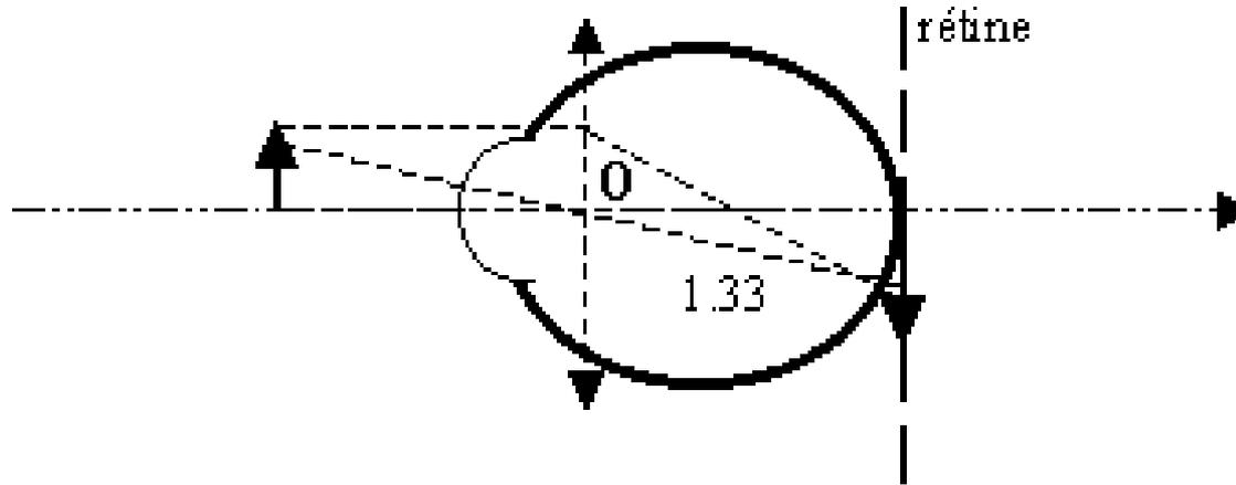
Cet ensemble composé par la rétine jouant le rôle d'un écran et le cristallin constitue l'œil réduit.
