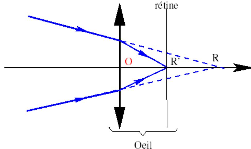
Correction: On place devant l'œil une lentille convergente qui permet de voir sans accommodation et qui donne d'un point à l'infini une image au PR. La lentille est placée de telle sorte que son foyer image le PR.
