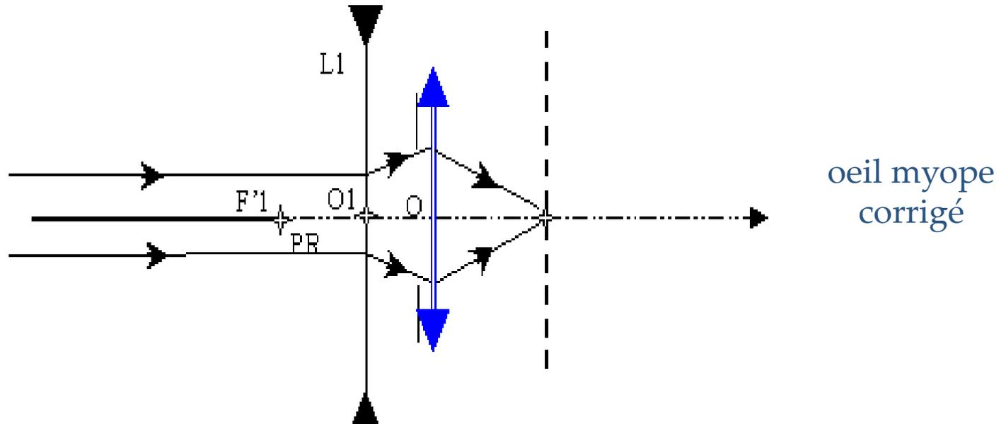
Pour un objet situé à l'infini et avec une lentille divergente  $L1$ , l'image est à nouveau sur la rétine.
