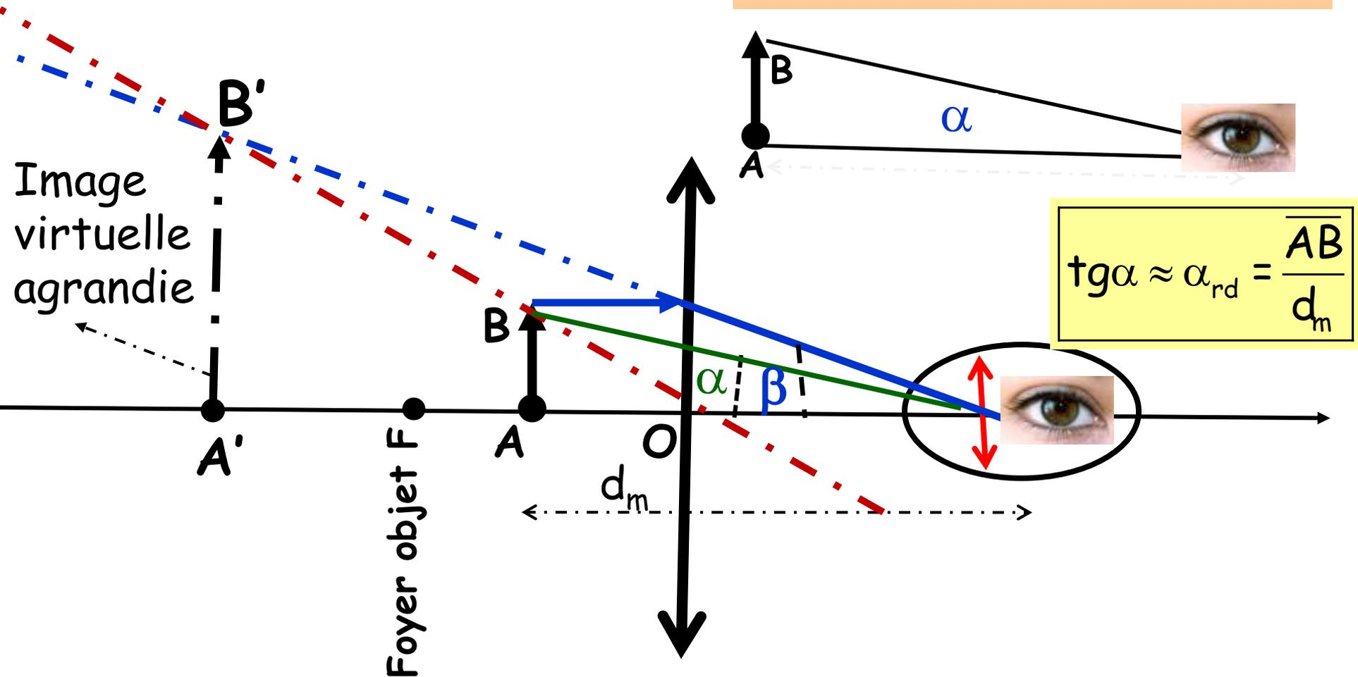
**Un microscope** est un instrument de très fort grossissement comprenant un **objectif**, assimilable à une lentille mince très convergente, et **un oculaire** jouant le rôle de loupe dans l'examen de l'image réelle, très agrandie, que l'objectif donne de l'objet examiné. Le microscope est alors l'association de deux systèmes convergents. Il sert à observer de petits objets rapprochés.
