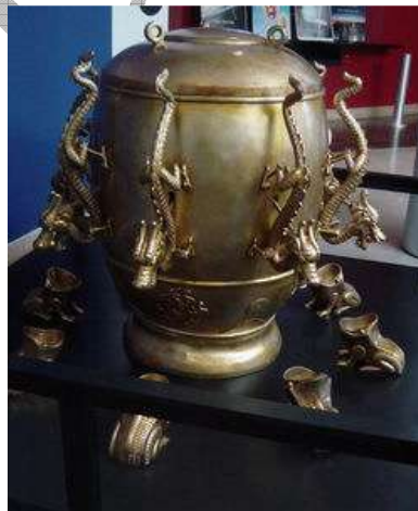
Figure 3.3 : Réplique du sismographe de Zhang Heng
