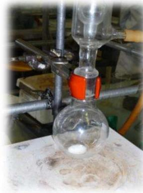
Il faut donc placer l'entrée d'eau **EN BAS** du réfrigérant afin que l'eau froide ait un contact maximal avec les vapeurs produites. La sortie est donc évidemment en haut du réfrigérant.
