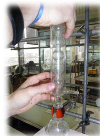
On graisse d'abord le rodage mâle du réfrigérant. (Éviter d'être trop « généreux » sinon une partie de la graisse risque de se retrouver dans la solution).
