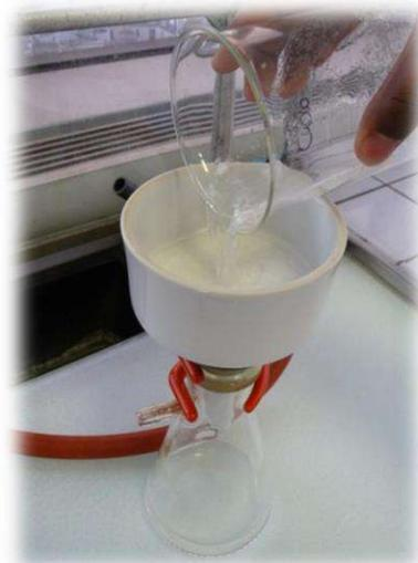
« casser le vide » en débranchant le tuyau entre la fiole et la trompe à eau ou le robinet du vide
