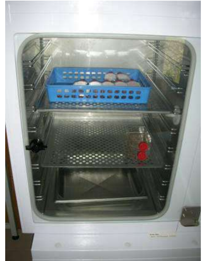
Bac d'eau stérilisée pour maintien d'un taux d'humidité suffisant
